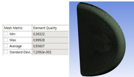
Fig. 7 Mallado tapas laterales
