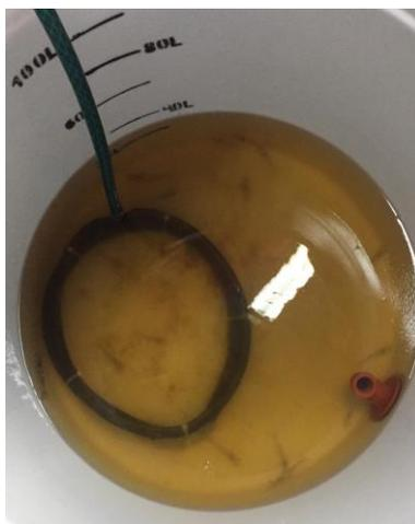
**Figura 9.** Forma del aireador conformado por manguera microporosa.
