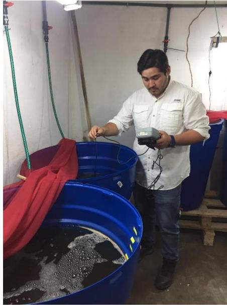
**Figura 16.** Toma del parámetro oxígeno con el equipo “multiparámetro YSI”.
