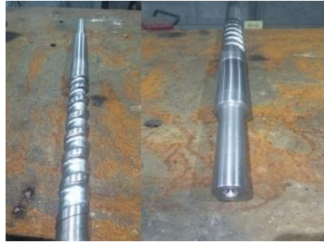
Figura 2: Maquinado del tornillo extrusor o husillo
