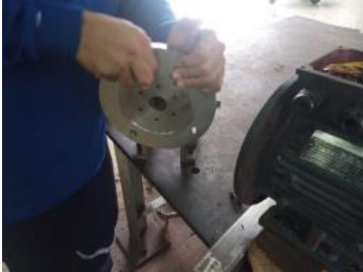
Figura 10: Maquinado de la brida entre el motor y el reductor de velocidad del eje extrusor
