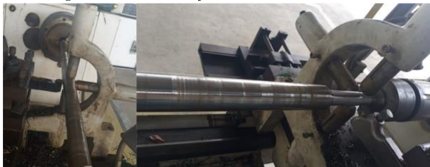
Figura 1: Fabricación del eje extrusor o cilindro de calefacción
