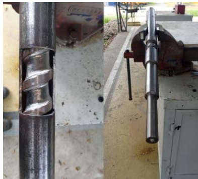
Figura 3: Acoplamiento del cilindro de calefacción con el tornillo sin fin o Husillo
