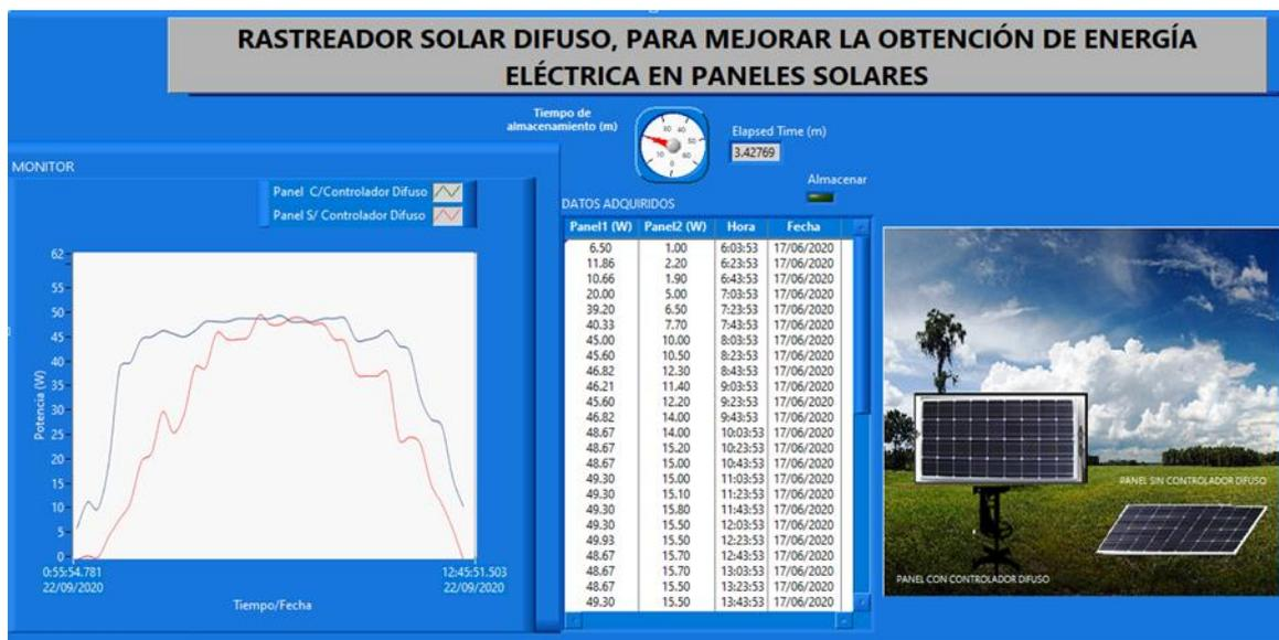
**Nota:** Esta interface fue desarrollado en LabVIEW 2018, los datos se obtienen mediante la comunicación con el microcontrolador por interface USB.
